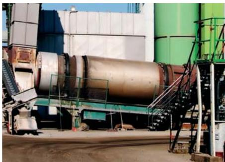
Exemple d'application : four tournant dans l'industrie chimique
