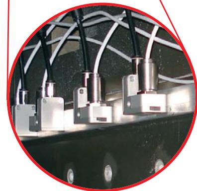
*Têtes de mesure optris CT LT de petites dimensions avec buse de soufflage à flux laminaire*
