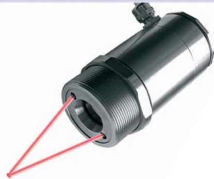
Visée à double laser pour marquage précis du spot de mesure à toute distance, par exemple 0,5 mm à une distance de 150 mm.
