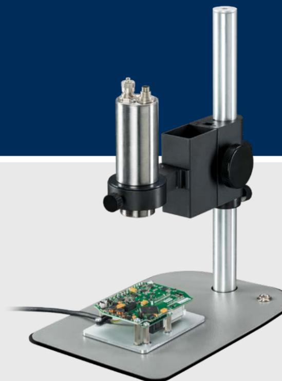
La nouvelle optique microscope pour la caméra infrarouge Xi 400 permet une mesure de la température sur de très petits objets, à partir de 240 µm.
