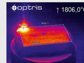
Mesure pendant le processus de soudure au laser
