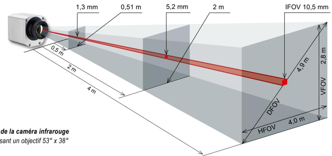
Champ de visée de la caméra infrarouge optris PI 450i utilisant un objectif 53° x 38°
